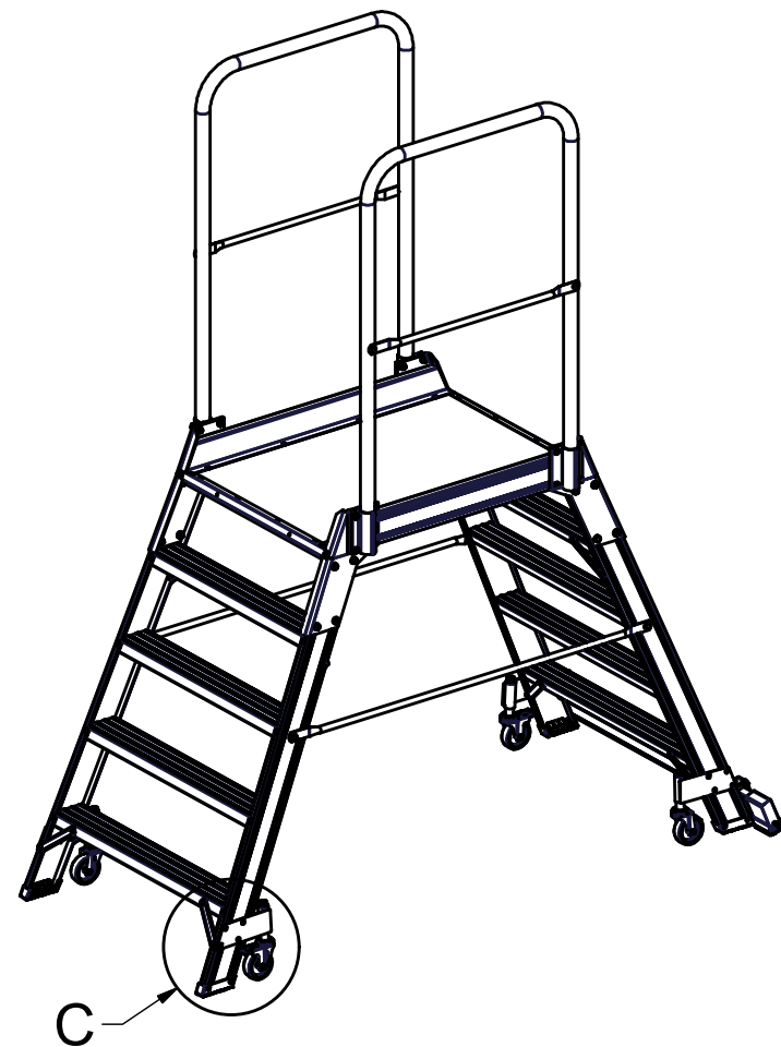
Návod na montáž koleček odpružených můstek 9703 až 9708.
